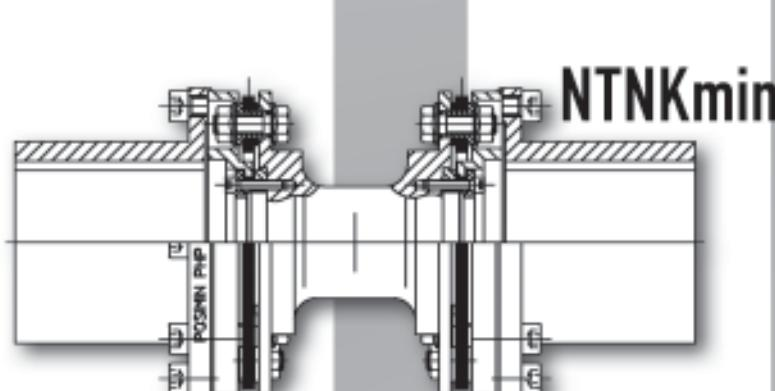
**POSIMIN PHP(min)** Ausführung **NTNK** mit Zwischenstück als Torsionswelle und Axialspielbegrenzung. Die Kupplung kann in Baulänge und Torsionssteifigkeit den Anforderungen entsprechend angepasst werden.
