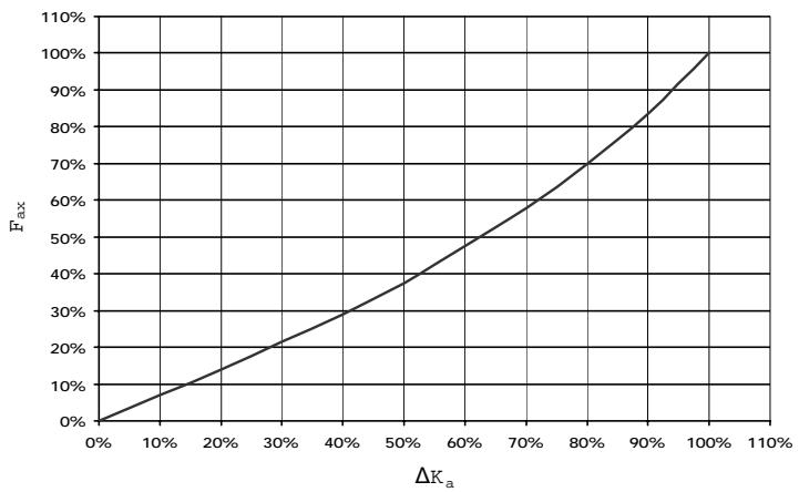
F<sub>ax</sub>: Max. Axialkraft der Kupplung bei max. axialer Auslenkung  $\Delta k_a$
